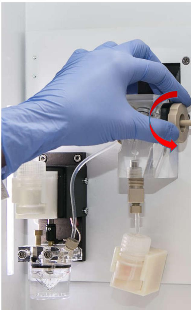
Рисунок 33. Ослабление фиксации винта
