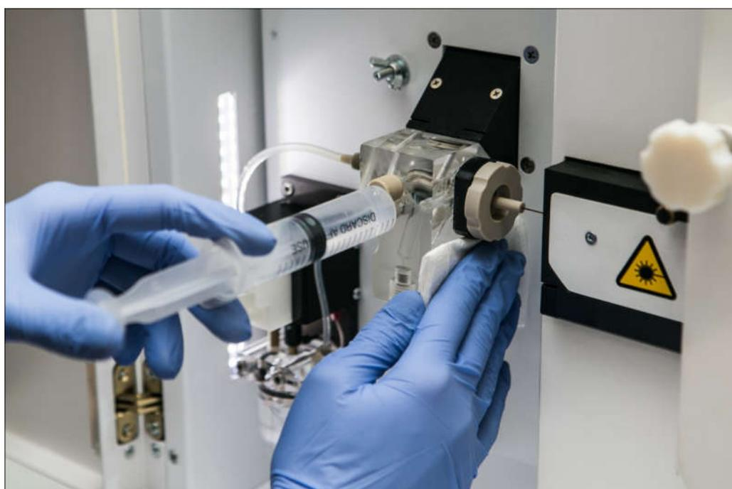
Рисунок 30. Промывка блока заполнения
