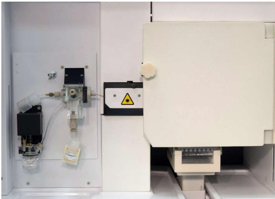
Рисунок 29. Вид внутренней части прибора с закрытой дверцей термостата и установленной линейкой капилляров
