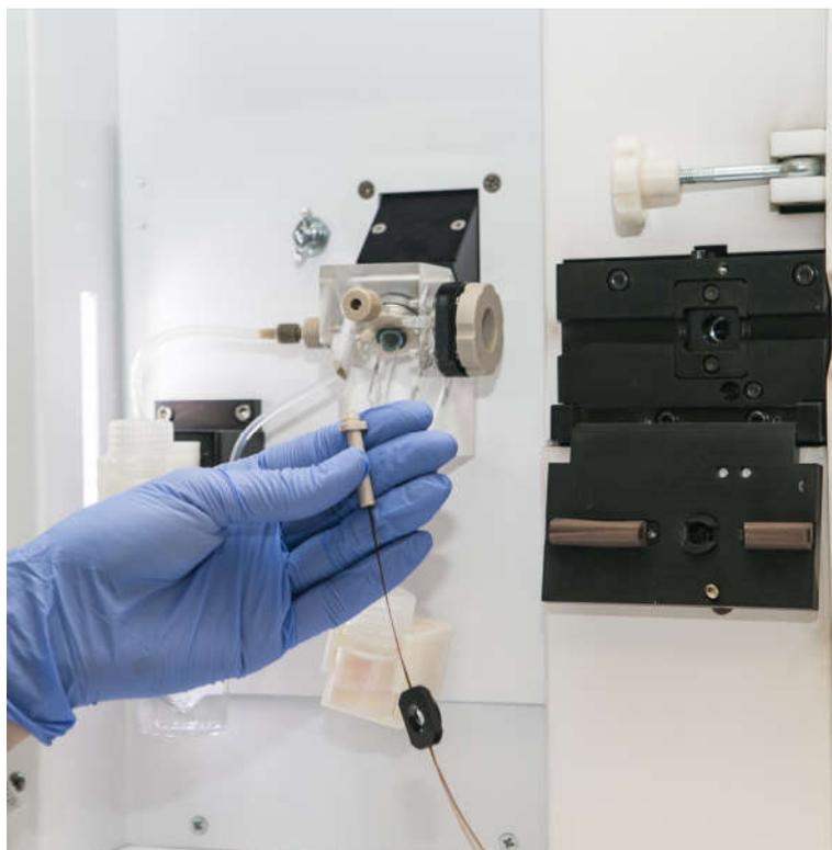
Рисунок 16. Наконечник линейки капилляров без фиксации винтом
