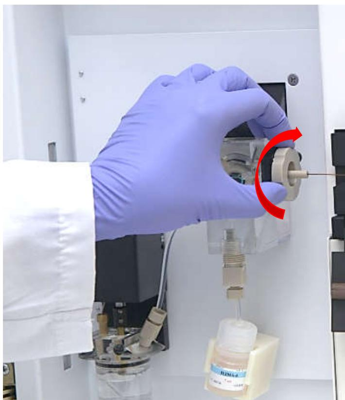
Рисунок 25. Фиксация наконечника линейки капилляров в блоке заполнения
