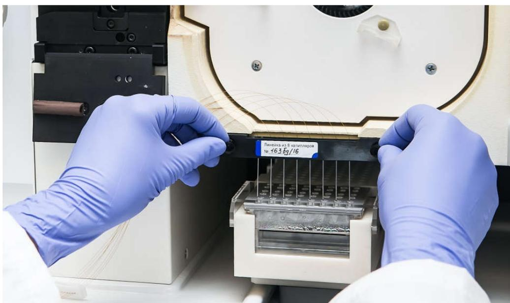
Рисунок 20. Закрепление планки линейки капилляров на термостате
