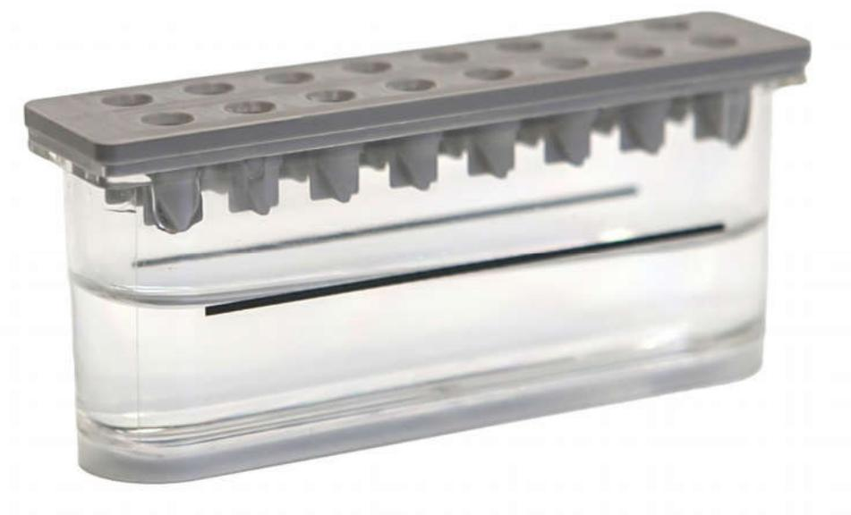
Рисунок 46. Заполненный резервуар с антииспарителем
