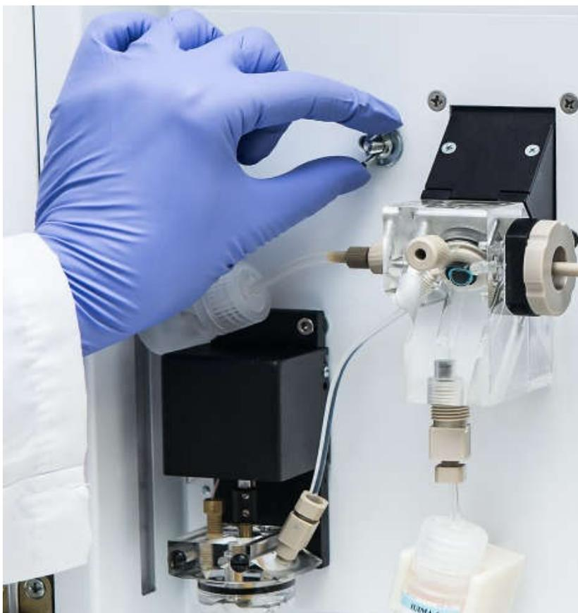
Рисунок 22. Ослабление фиксации плиты блока заполнения капилляров
