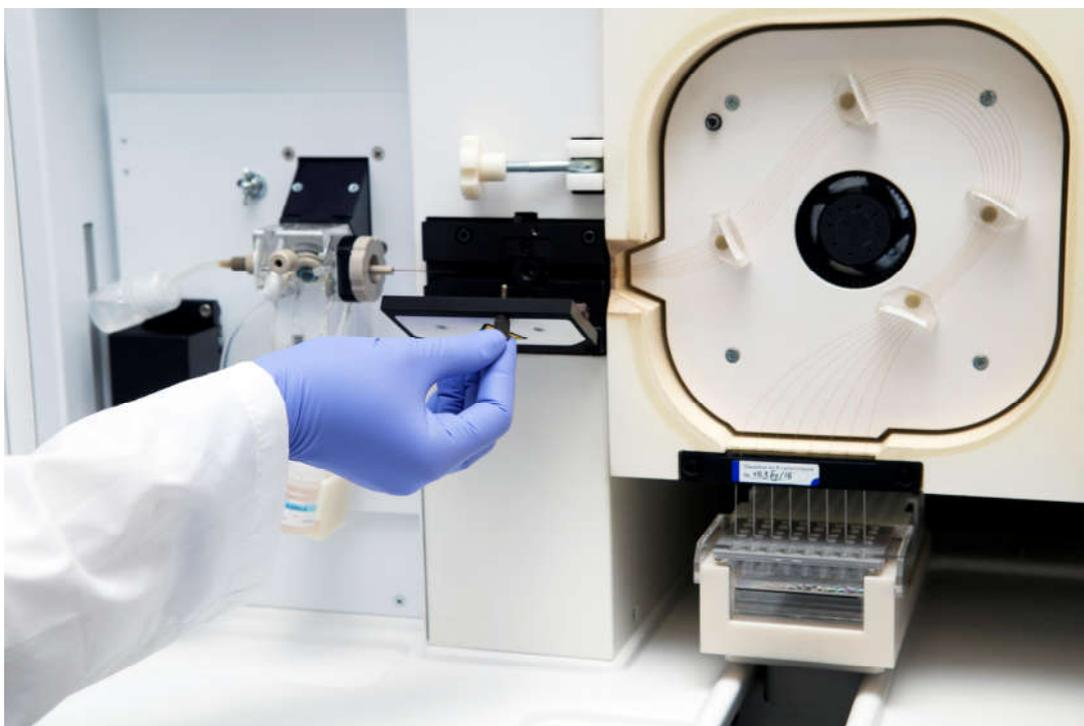
Рисунок 9. Дверца термостата открыта, позиционер опущен, крышка детектора открыта
