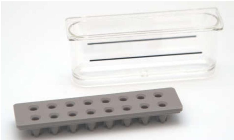
Рисунок 44. Пустой резервуар с антииспарителем
