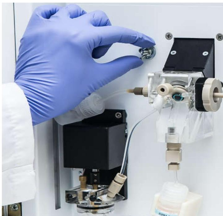
Рисунок 13. Ослабление фиксации плиты блока заполнения капилляров
