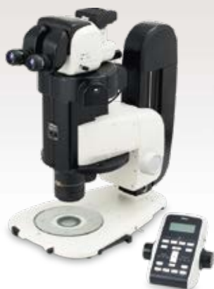
SMZ25 Моторизованная модель с самым высоким коэффициентом трансфокации и разрешением в серии SMZ
