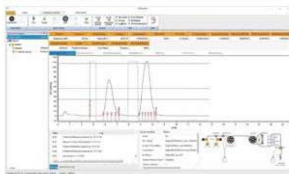
На интерфейсе управления приборами в режиме реального времени отображаются рабочие данные, хроматограммы, журналы регистрации операций и путь потока системы прибора.
