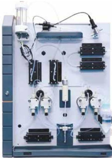
**Unique AutoPure Pilot600** – это полупромышленная настольная хроматографическая система для пилотного выделения биопрепаратов на стадии клинических испытаний и не только.
